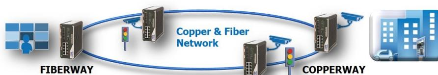
Les villes intelligentes nécessitent une connectivité multiservice, non seulement pour la vidéosurveillance en Ethernet et POE, mais aussi pour l'intégration du contrôle de la signalisation tricolore, des PMV, des bornes escamotables, du comptage. Les solutions CopperWay et FiberWay offrent cette multiplicité de services et d'interfaces de communication sur des liens en paires de cuivre et sur fibres optiques.
