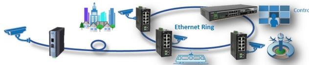
Le switch Ethernet assure plusieurs fonctions dans le réseau : raccordement de la caméra et son alimentation en POE, gestion du réseau avec résilience, VLAN, QoS, contrôle des flux multicast avec IGMP et des risques de congestion, sécurisation du réseau. Le switch assure aussi l'agrégation des flux vidéo et ses capacités de commutation et de traitement doivent être dimensionnées en conséquence.
