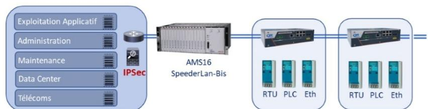
Le **CopperWay-Bis-6TTX** assure le raccordement d'équipements en interface Ethernet en chaque point d'une infrastructure en paires de cuivre et/ou fibre optique. Il délivre toutes les interfaces de communication Ethernet nécessaires aux applications métiers. Il fournit un très haut niveau de sécurité hardware et software à ces applications critiques.
