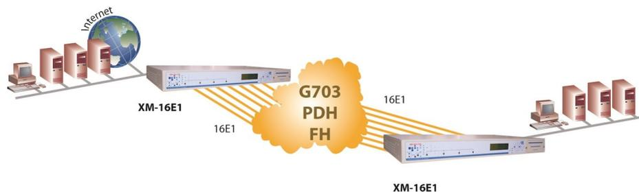
Ou bien le **XM-M16E1T1-4TTX** est utilisé en solution de multiple point à point utile notamment dans les grandes infrastructures de l'énergie, du transport ou de l'armée. On peut mettre en place depuis chaque XM-16E1, plusieurs liaisons, jusqu'à
