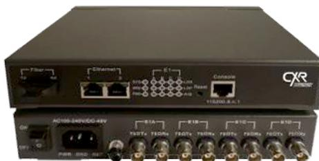
Le XM-F8E1-4TTX utilise permet des liaisons point à point via de E1 transportés par des faisceaux hertziens comme des E1 traversant un réseau SDH acceptant des délais entre E1 de 220ms. Le temps de transit impacté par l'agrégation des E1 est négligeable.
