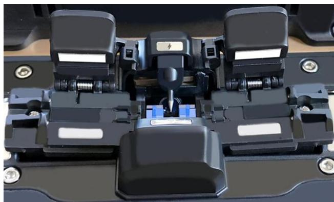
Le support de fibre assure un maintien et un positionnement de grande précision
