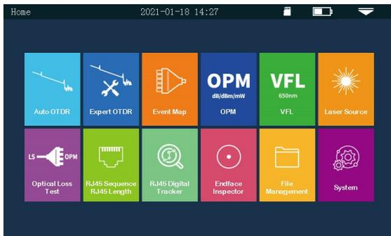
Menu principal : accès aux mesures OTDR, source optique, photomètre, source rouge VFL, test Ethernet RJ45, et aux menus d'exploitation des données et de configuration
