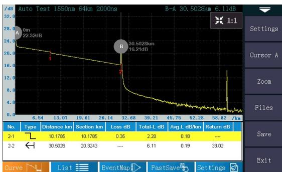
La mesure OTDR en automatique restitue une courbe graphique d'affaiblissement et de caractéristique des évènements détectés par réflectométrie. Chaque évènement est caractérisé par sa distance, l'affaiblissement, et le type de défaut (épissure, connecteur, rupture)
