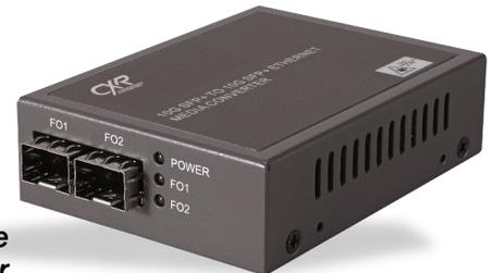
*Le FOC-USFP-USFP est un convertisseur de média optique performant automatique pour les liaisons optiques Fast-Ethernet ou Gigabit-Ethernet ou pour l'interconnexion d'équipements Ethernet optique de toute marques. Ce convertisseur adapte automatiquement le débit optique des équipements d'extrémité optique ou le débit peut être choisi par DIP switch. La fonction « débrayables » Link Alarme » informe le coté opposé de la coupure de fibre. Il est utilisé seul ou en châssis RACK-MEDIA16.*
