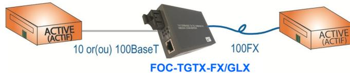
Les **FOC-TGTX** peuvent être utilisés comme une extension de LAN ou liaison de deux brin de LAN par une fibre optique, n'entamant en rien le débit du LAN du fait du débit de transfert à 200Mbps ou 2000Mbps et du mode de switch Store-and-Forward dé-activable avec un filtre à 148,8Kbps ou 1488kbps.
