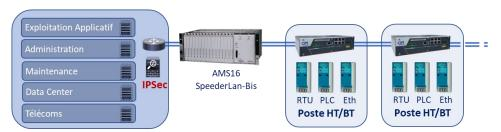
Le **CopperWay-Bis-HV3** assure le raccordement d'équipements en interface Ethernet en chaque point d'une infrastructure en paires de cuivre et/ou fibre optique dans des ouvrages à haute tension. Il délivre toutes les interfaces de communication Ethernet nécessaires aux applications métiers. Il fournit un très haut niveau de sécurité hardware et software à ces applications critiques.
