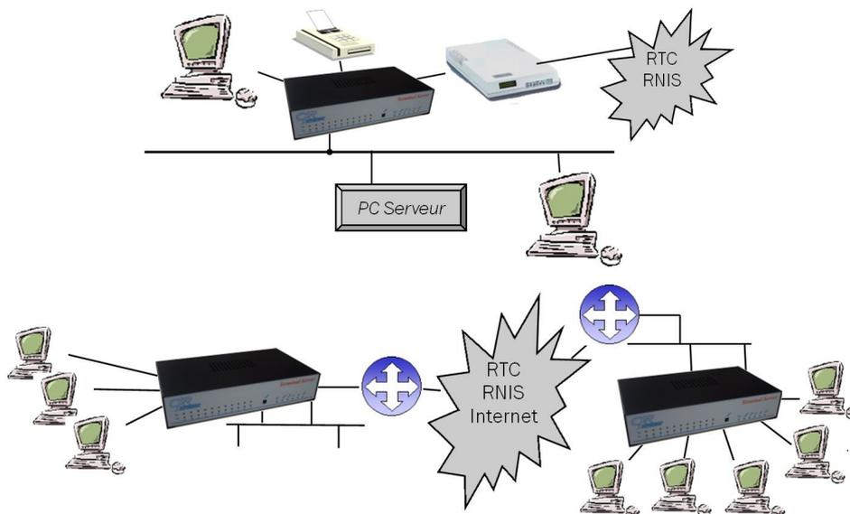
Parfaitement intégré au réseau TCP-IP, le TS 324 permet l'interconnexion d'équipements V24/RS232 via un réseau local et étendu.
