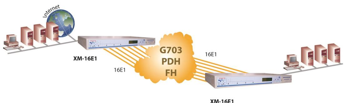
Le **XM-M16E1T1-4TTX** est équipé côté Convertisseur Ethernet de 4 ports Ethernet 10/100BaseT et d'un port SNMP, d'une carte optionnelle fibre optique 100FX, puis côté WAN de 1 à 4 tiroirs extractibles : 4 E1 120ohms en RJ45 ou en DB25 pour une nappe de câbles avec 4 RJ45, ou 4 E1 75ohms en mini BNC ou en DB25 pour une nappe de câbles avec 8 BNC.
