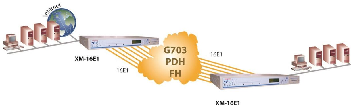
Ou bien le XM-M16E1T1-4TTX est utilisé en solution de multiple point à point utile notamment dans les grandes infrastructures de l'énergie, du transport ou de l'armée. On peut mettre en place depuis chaque XM-16E1, plusieurs liaisons, jusqu'à 16 de n1 E1, n2 E1, n3 E1, n4 E1..... avec  $n1+n2+n3+n4+\dots=16$  maximum.
