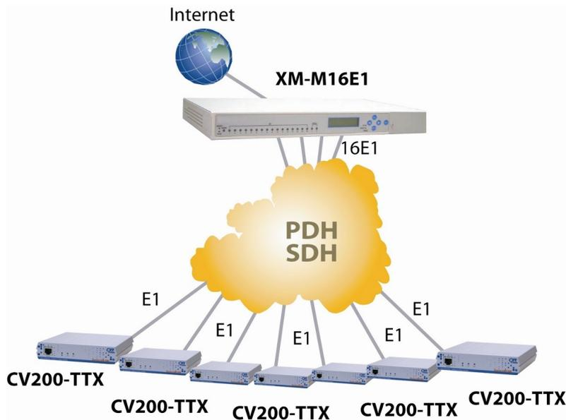
Le **XM-M16E1T1-4TTX** peut être aussi utilisé en solution de concentration de 16 liens Ethernet sur E1 provenant d'un convertisseur Ethernet **CV200-TTX**.
